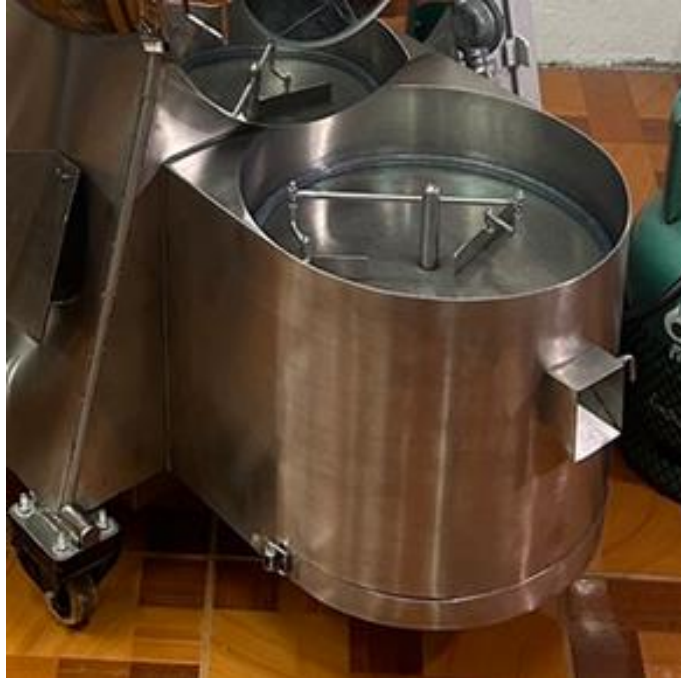
ภาพที่ 3 สร้างส่วนสร้างโครงสร้างสแตนเลสและระบบระบายความร้อน
