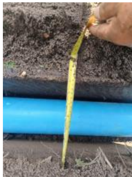
ภาพที่ 14 ความกว้างร่องที่ได้จากเครื่องขุดดินฝังท่อ
